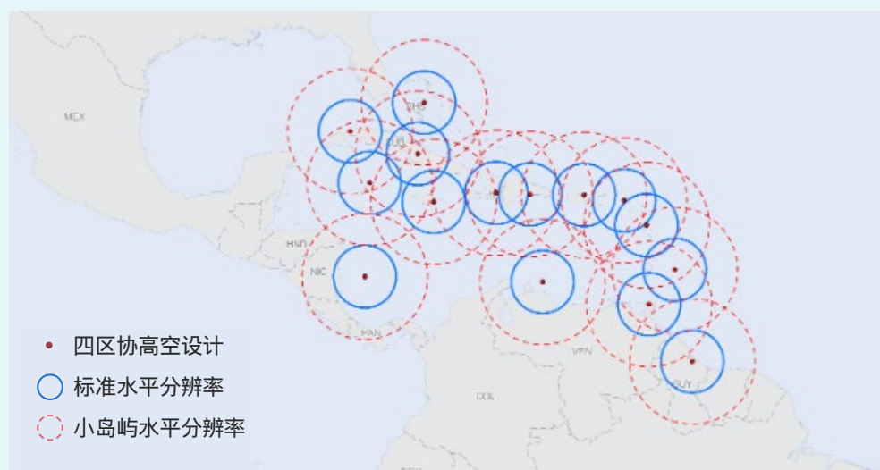
图13： 四区协高空GBON组成部分的区域设计及加勒比地区覆盖范围。蓝色圆圈表示GBON标准水平分辨率，红色虚线圆圈表示小岛屿GBON水平分辨率。
