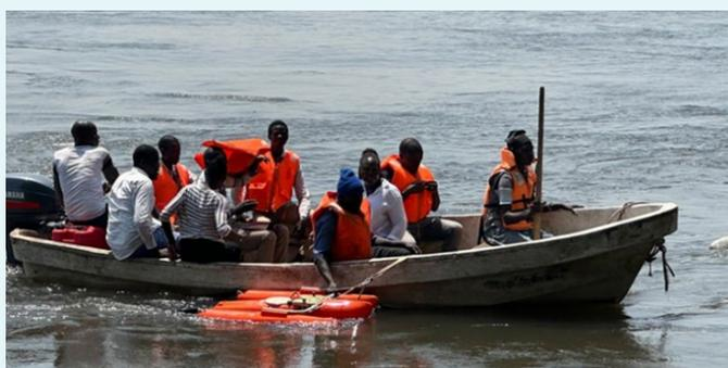
**Figure 24.** Le personnel du SHN mesure le débit d'un cours d'eau à l'aide d'un profileur de courant à effet Doppler pendant une formation sur l'hydrométrie offerte à Djouba, dans le Soudan du Sud
