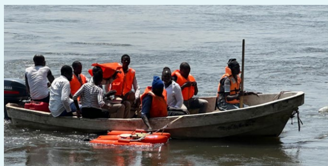
Figura 24. Personal del SHN realiza mediciones del caudal de un arroyo utilizando un perfilador de corrientes acústico Doppler durante un curso de formación en hidrometría en Juba (Sudán del Sur)
