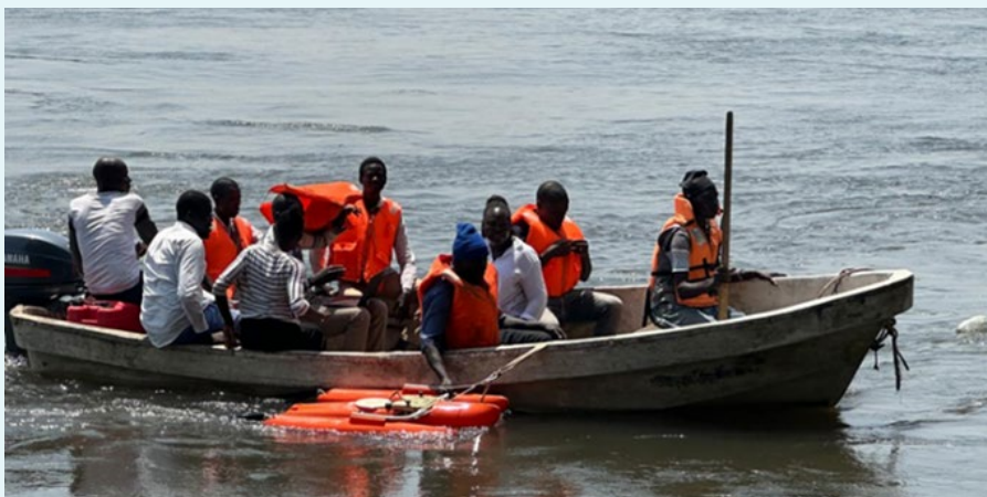
Рисунок 24. Сотрудники НГС проводят измерения стока с помощью акустического профилометра Доплера для измерения течения во время обучения в области гидрометрии в Джубе, Южный Судан
